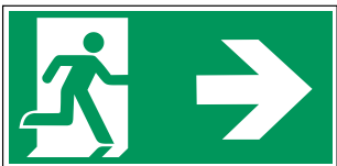
Beispiel für Rettungsweg/Notausgang (E002) mit Zusatzzeichen (Richtungspfeil)
